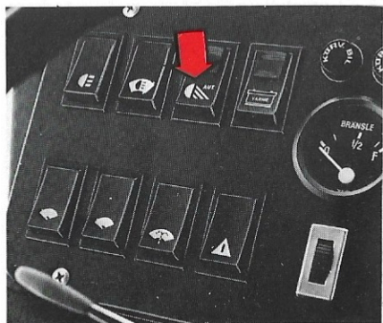
Bild 22. Strömställare för halvljusautomatik
