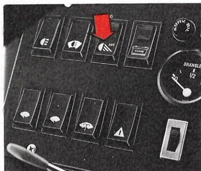
Bild 28. Strömställare för halvljusautomatik
